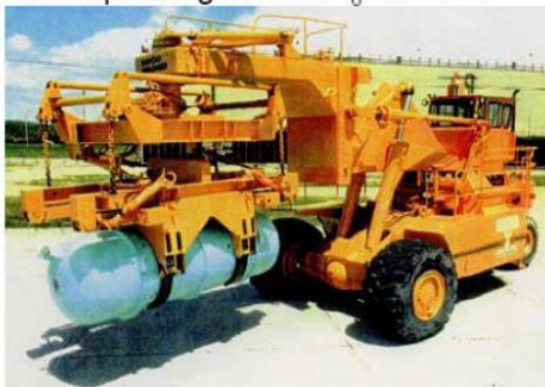
Transportwagen mit \text{UF}_6 -Behälter
